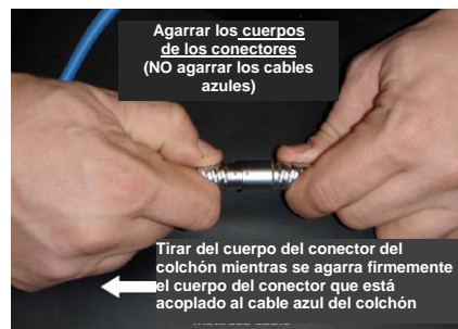
Figura 2: Desconexión del cable
