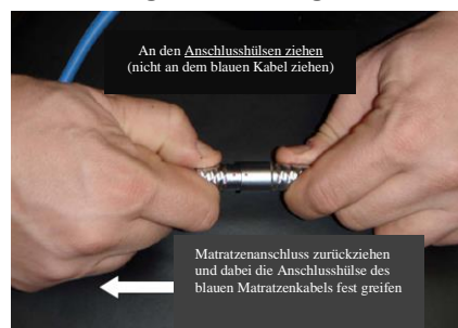
Abbildung 2: Trennung der Kabel
