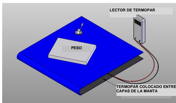
Figura 5: Configuración de pruebas de manta de calentamiento
