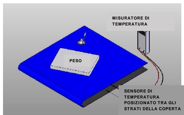
Figura 3: Configurazione del test della coperta di riscaldamento
